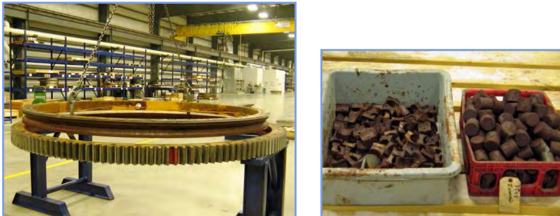
Figura 1 - Ralla di rotazione a rulli incrociati con dentatura esterna: Anelli, rulli e distanziali ricevuti per la riparazione.
