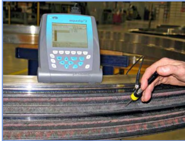
Figura 3 – Misura della durezza della pista di rotolamento
